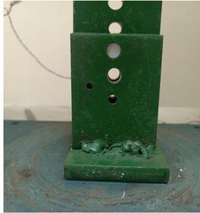
الشكل رقم (7): تثبيت قرص الزيركونيا ضمن وحدة الاختبار الميكانيكي
