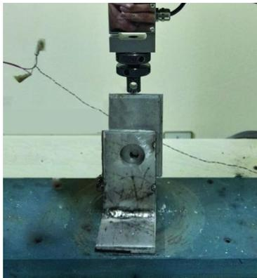
الشكل رقم (3): اختبار قوة القص
