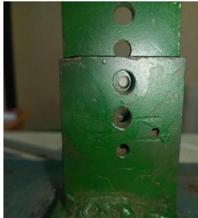
الشكل رقم (8): تثبيت قرص الراتنج المركب ضمن وحدة الاختبار الميكانيكي
