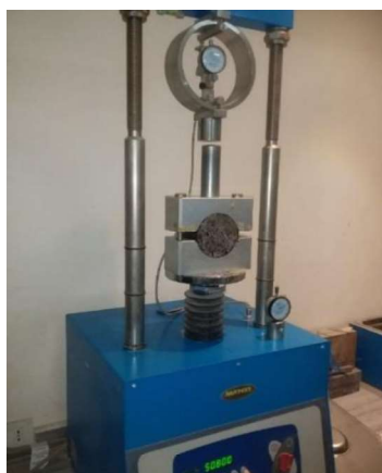
الشكل رقم (9): صور من مراحل تحضير واختبار عينات الخلطة الإسفلتية
