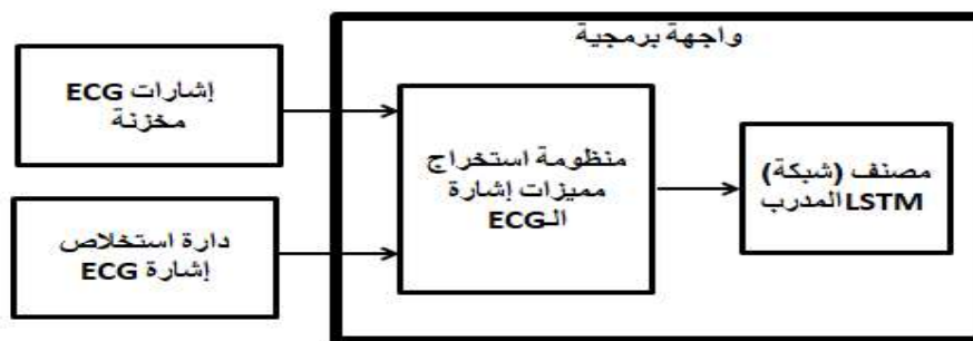
الشكل رقم(1): المخطط الصندوقي للمنظومة المصممة
