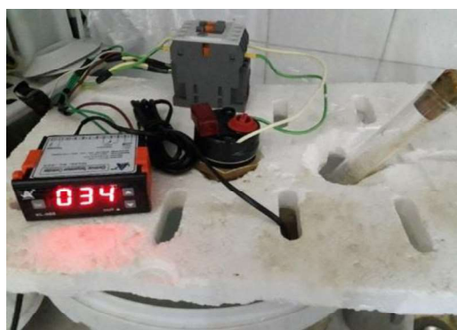
الشكل رقم (4): وعاء التخمير مع سخان ومثبت حرارة
