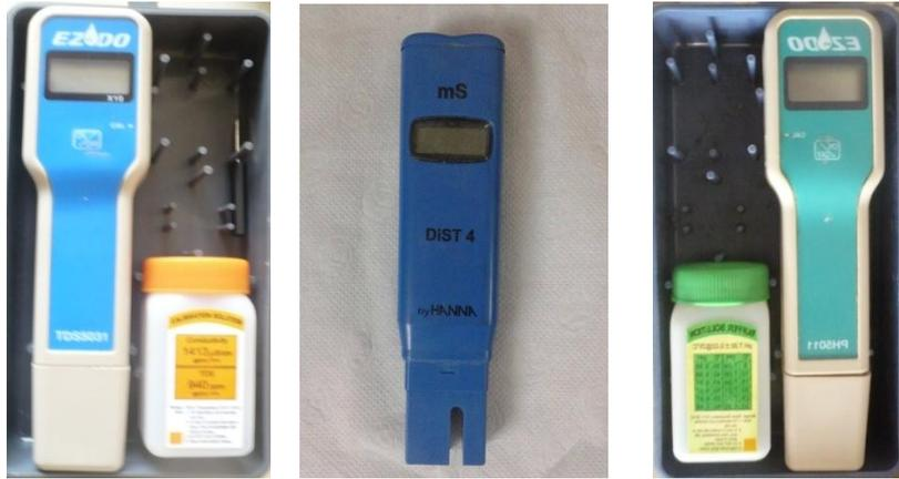
الصورة رقم(2): تظهر أجهزة قياس NaCl -pH -TDS المستخدمة في الدراسة
