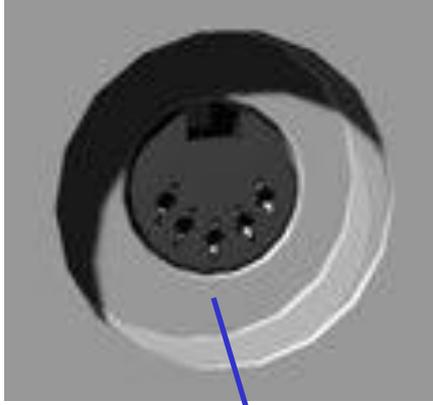
يصل منفذ لوحة المفاتيح هذه اللوحة بجهاز الحاسب . و يأتي منفذ لوحة المفاتيح بحجمين مختلفين .
