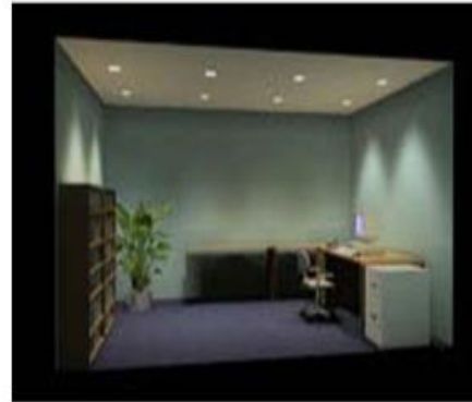
إنارة مباشرة (Downlight)
