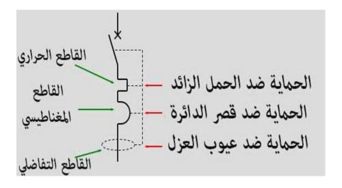
فالقاطع الحراري يستعمل للحماية ضد الحمل الزائد و يرمز له بنصف مستطيل. و القاطع المغناطيسي يستعمل للحماية من قصر الدائرة و يرمز له له بنصف دائرة. أما القاطع التفاضلي(DDR) فيحمي الإنسان من تسرب التيار و يرمز له بالشكل البيضاوي.
