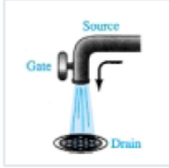
الشكل (3.3) التشابه بين آلية عمل صنوبر الماء وآلية تحكم الترانزستور JFET
