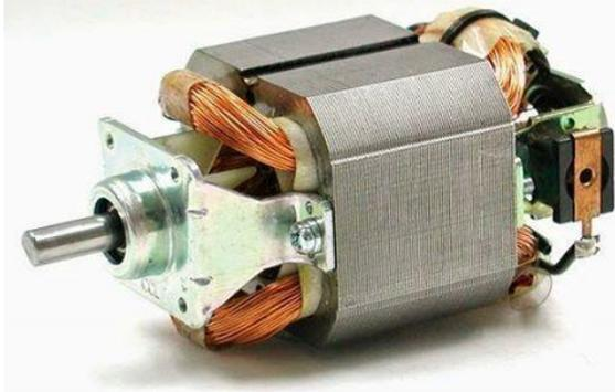
عند تغذية كل من ملفات حقل التهييج في الثابت وملفات المتحرض في الدوار بالتيار الكهربائي (متناوب - أو - مستمر) تتفاعل خطوط القوى المغناطيسية المتولدة بواسطة ملفات حقل التهييج مع خطوط القوى المتولدة من المتحرض فينتج عزم دوران يدير المحرك.
