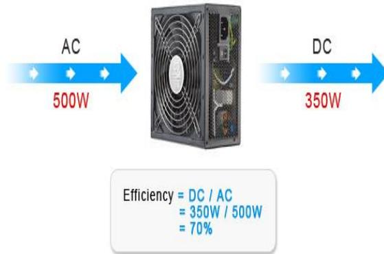
كفاءة مزود الطاقة تساعد توفير في استهلاك الكهرباء أي أنك تضمن أن مزود الطاقة يستهلك معظم ما يسحبه من كهرباء بدون تبديد.
