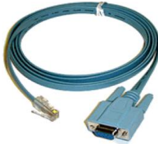
الشكل (6.12): كابل توصيل الموجه عبر منفذ Console.
