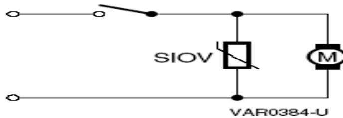
تمثل هذه الدارة لحماية المحرك، فعند ارتفاع الجهد بشكل مفاجئ تنقص قيمة المقاومة VDR مما يؤدي الى مرور التيار في الفرع الموجود فيه المقاومة وبالتالي حماية المحرك.
