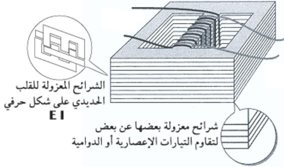
ولكن يعيب على مثل هذا النوع من الملفات ، أن تيارات متولدة بالحث الذاتي داخل القلب الحديدي تسمى بالتيارات الإعصارية أو التيارات الدوامية ، تتحرك في اتجاهات عشوائية داخل هذا القلب مما يسبب ارتفاع درجة حرارة القلب المغناطيسي وفقد في الطاقة . ولذلك يقسم القلب الحديدي إلى شرائح معزولة عن بعضها البعض لتقاوم التيارات الإعصارية أو الدوامية .
