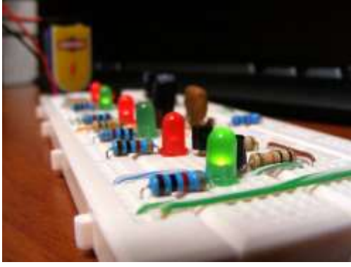
الشكل ١ لوحة تجارب مثبت عليها دائرة إلكترونية كاملة
