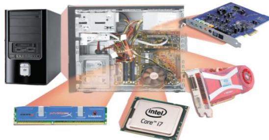
تحتوي وحدة النظام **اللوحة الأم Motherboard** (لوحة النظام) والتي يتم ربط كافة مكونات الكمبيوتر بها. كما ترتبط بهذه اللوحة كافة المنافذ والمكونات الأخرى مثل بطاقة الشاشة وبطاقة الصوت والمعالج والذواكر وبطاقة الشبكة وغيرها.
