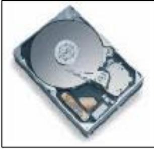
محكمة الإغلاق، ومفرغة من الهواء. يعد القرص الصلب أكبر مخزن للبيانات في جهاز الحاسوب، ويمتاز القرص الصلب بسرعة وصول البيانات إليه مقارنة بالأقراص الأخرى. ويمتاز أيضاً بإمكانية حفظ البيانات عليه بشكل دائم سواء في أثناء العمل على الحاسوب أو حتى بعد إطفاء الحاسوب، مع إمكانية
