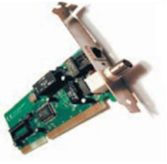
٤. بطاقات الشبكة **Network Interface Card** هي بطاقة تثبت بالحاسوب لتهيئته للاتصال بالشبكة، وتوجد البطاقة إما داخلية Internal تثبت على اللوحة الأم Mother Board داخل الحاسوب أو خارجية External.
