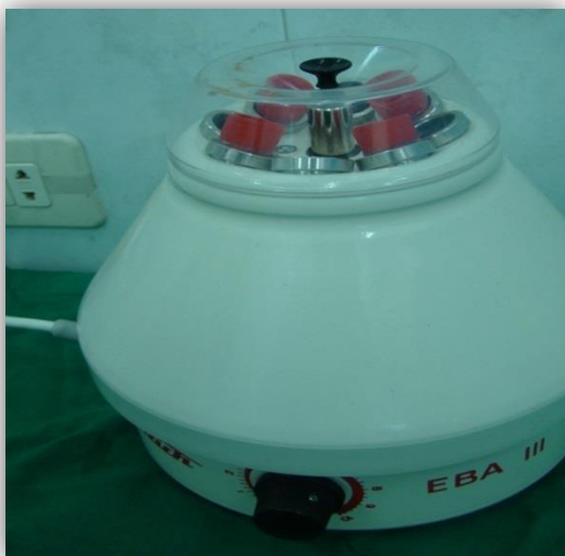
الشكل رقم (54) المُثقلة المستخدمة في البحث ( Hettich Zentrifuge EBA 3 )
