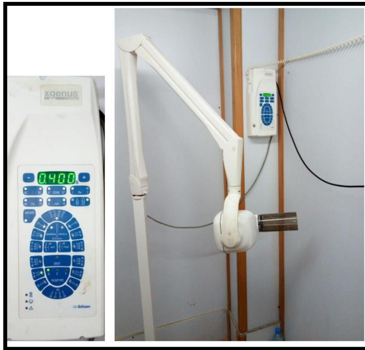
الشكل رقم (56) جهاز التصوير الشعاعي xgenus ®، من شركة de Gotzen
