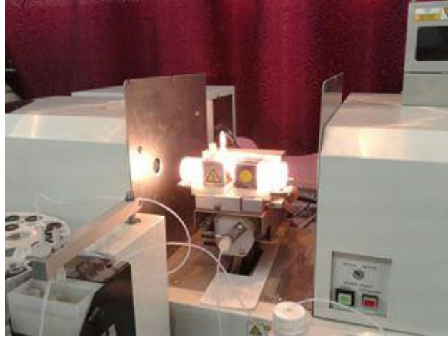
(الشكل رقم 17) الفرن الغرافيتي أثناء تسخين العينات
