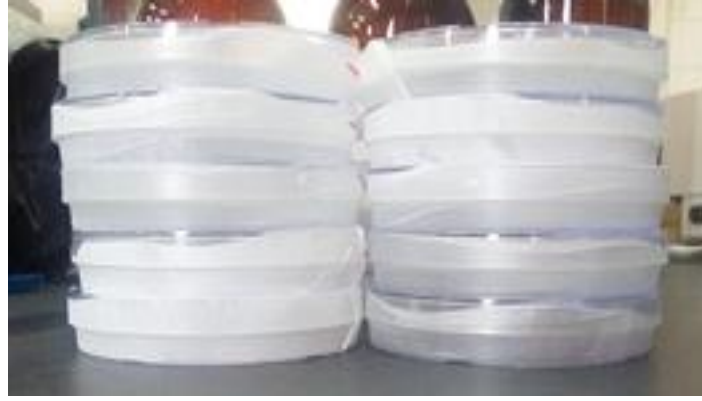
(الشكل رقم 11) يبين الأطباق مختومة جيداً بعد وضع الأسلاك ضمنها وغمرها في 25 مل من اللعاب الاصطناعي
