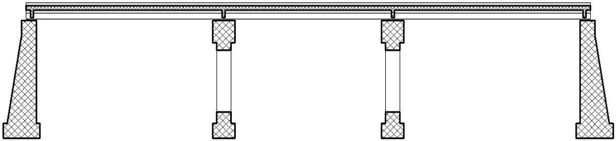
الشكل (٢٢-٤) مقطع طولى في الجسر بدون أتربة
